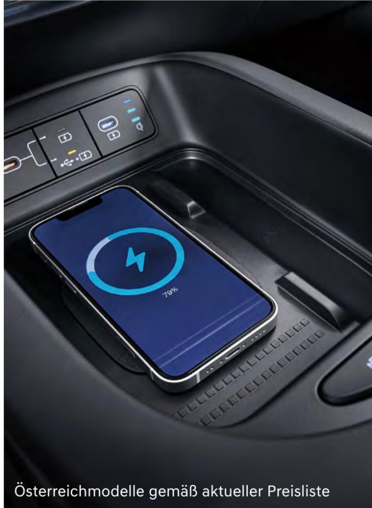
Die induktive Ladestation in der Mittelkonsole verfügt über eine integrierte Kühlfunktion die eine Überhitzung des Smartphones verhindert.
