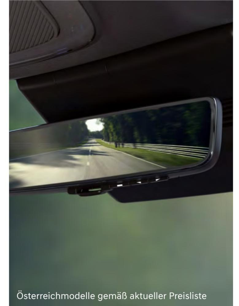
Dank Smart-View-Technologie zeigt der Digitale Innenspiegel auf Wunsch das Bild einer im Spoiler montierten Kamera. So hat man selbst bei eingeschränkter Sicht einen guten Blick nach Hinten.
