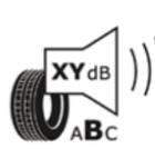
Die Geräuschklasse (Außengeräuschpegel in Dezibel) reicht von A (weniger Geräusche außerhalb des Fahrzeugs) bis E (mehr Geräusche) – Reifen mit Geräuschklasse C sind nicht mehr erlaubt. Dieses Geräusch unterscheidet sich vom „Hohlraumgeräusch“, bei dem es sich um jenes Geräusch handelt, das von den Felgen auf den Innenraum des Fahrzeugs übertragen wird.
